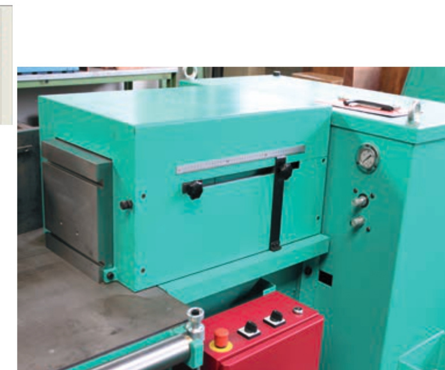
Ручное управление с точной регулировкой хода
