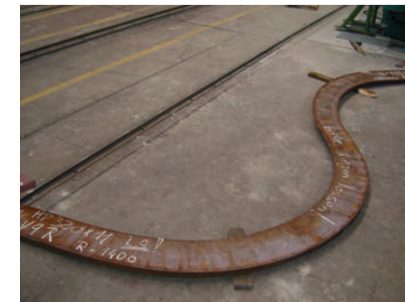
Гибка „S-образных изгибов“ возможна при смене инструмента
