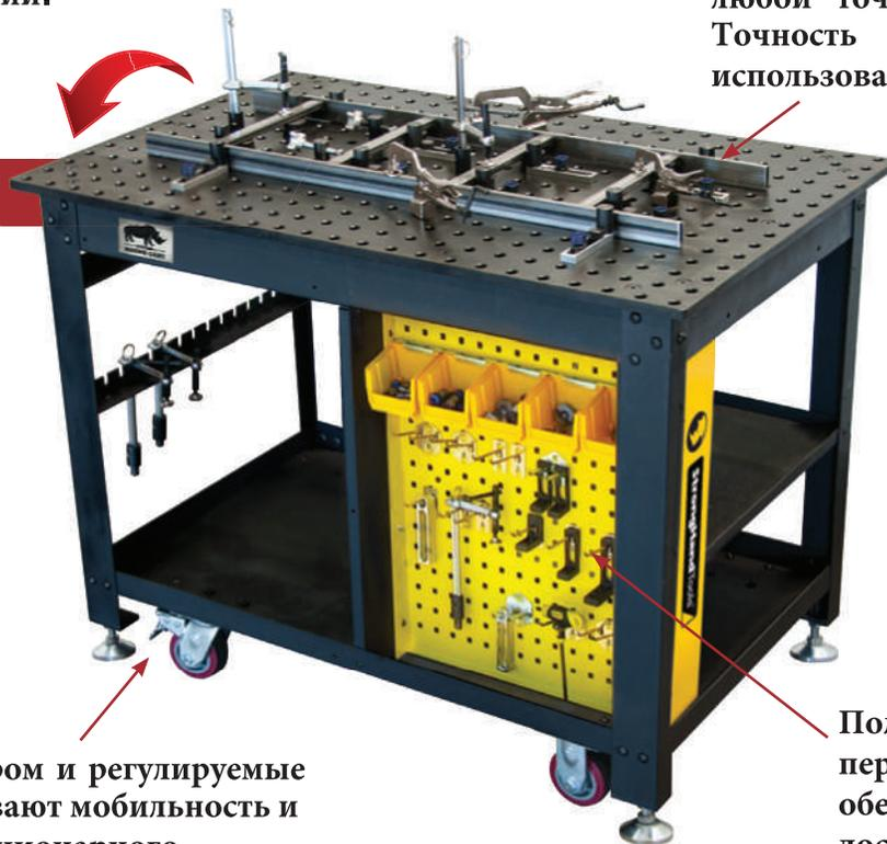
Ролики со стопором и регулируемые ножки обеспечивают мобильность и подойдут для стационарного использования
