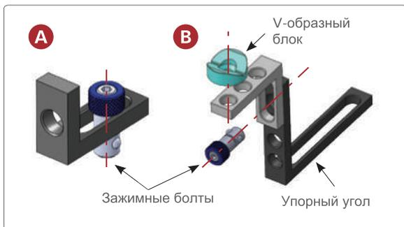
Фиксация и позиционирование. Комбинируйте упорные углы для подъема и фиксации деталей круглого сечения
