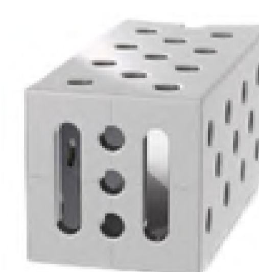
комбинация отверстие/слот на торцевых поверхностях*
