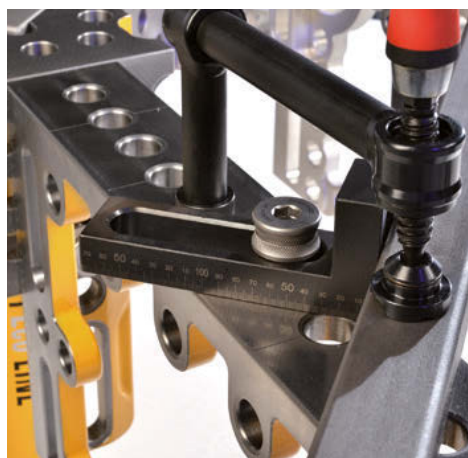
Точная регулировка с помощью точной шкалы
