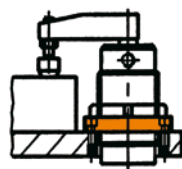
Резьбовым фланцем и шлицевой гайкой
