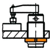
Шлицевыми гайками снизу
